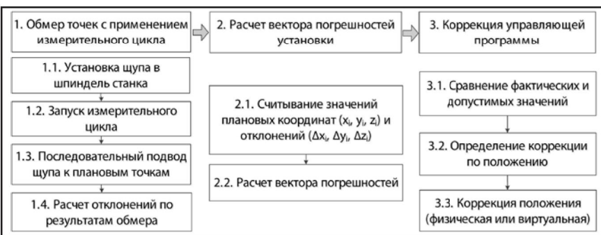
Рис. 4. Последовательность обработки цикла определения и коррекции положения заготовки
