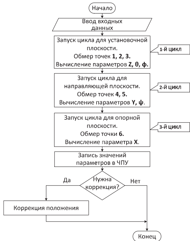
Рис. 3. Блок-схема цикла определения положения заготовки
