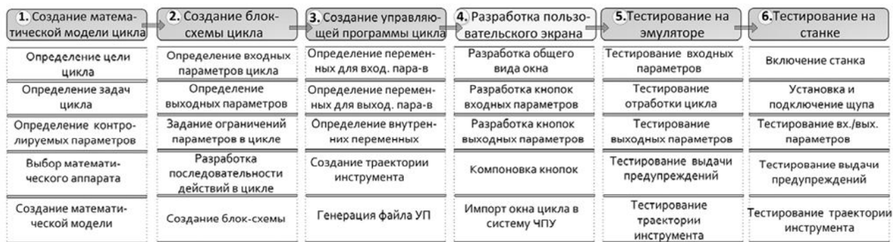
Рис. 1. Методика разработки цикла определения положения заготовки на столе станка с ЧПУ
