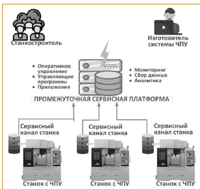
Рис. 1. Облачная инфраструктура системы прогнозирования и поддержки здоровья станка
