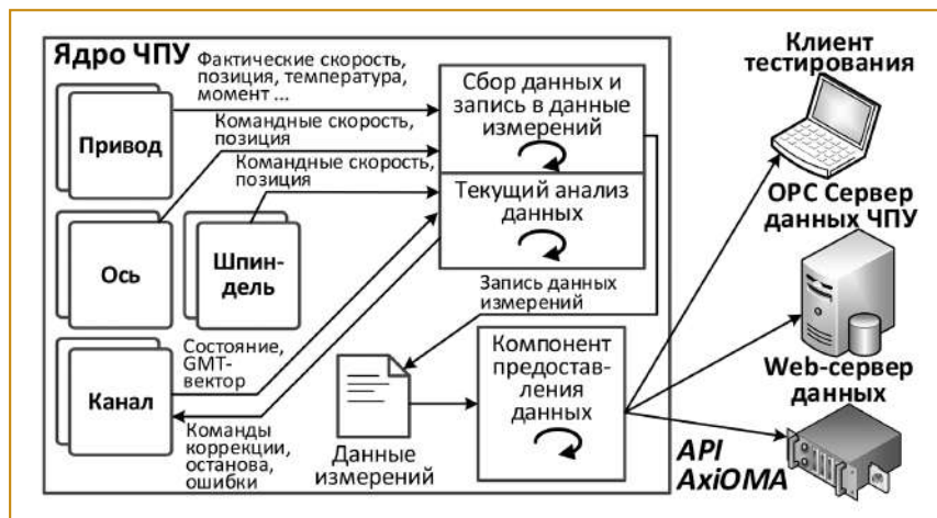
Рис. 2. Структура компонентов в ядре для определения состояния здоровья
