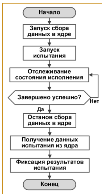
Рис. 4. Алгоритм испытания и получения данных от станка
