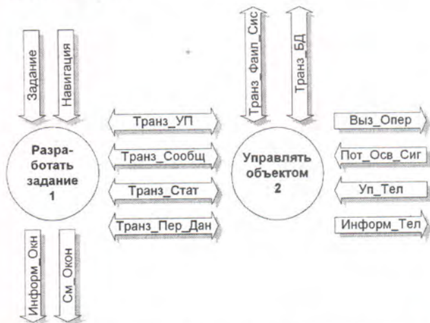
Рис. 4. Декомпозиция процесса "Выполнить задание": Транз_УП — транзакции управляющих программ; Транз_Сообщ — транзакции сообщений для поля сообщений на экране; Транз_Стат — транзакции статусов для поля статусов на экране; Транз_Пер_Дан — транзакции данных для управляющих элементов экрана; остальные обозначения см. на рис. 3
