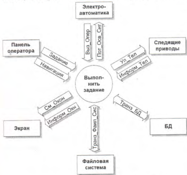
Рис. 3. Исходная диаграмма DFD-модели: См_Окон — смена окон экрана; Информ_Окн — информация для окон; Транз_Файл_Сис — транзакции файловой системы; Транз_БД — транзакции БД; Информ_Тел — информационная телеграмма от следящих приводов подачи; Уп_Тел — управляющая телеграмма приводам подачи; Пот_Осв_Сиг — поток сигналов от приводов электроавтоматики; Выз_Опер — вызов операций электроавтоматики
