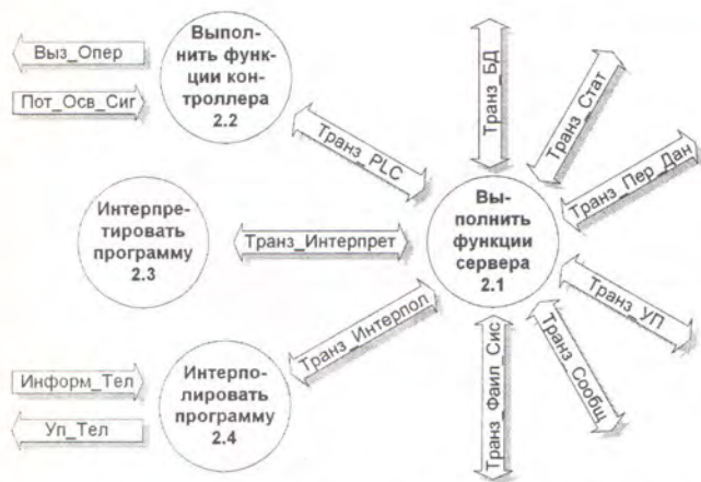
Рис. 6. Декомпозиция процесса "Управлять объектом": Транз_Интерпол — транзакции интерполятора; Транз_Интерпрет — транзакции интерпретатора; Транз_ПЛС — транзакции PLC; остальные обозначения см. на рис. 3—5
