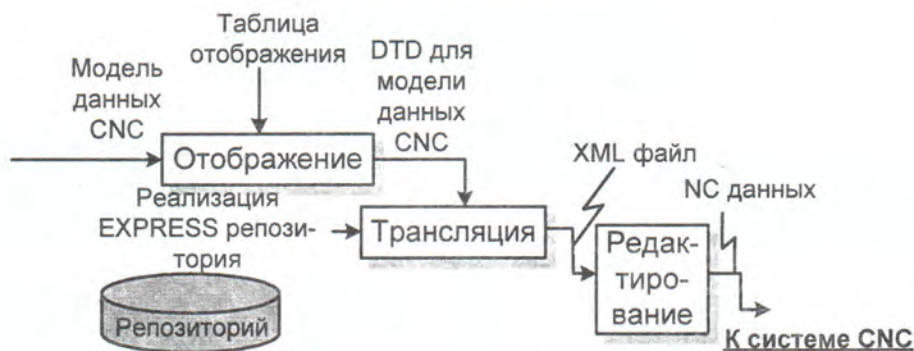
Рис. 9. Схема генерации управляющей XML-программы ЧПУ
