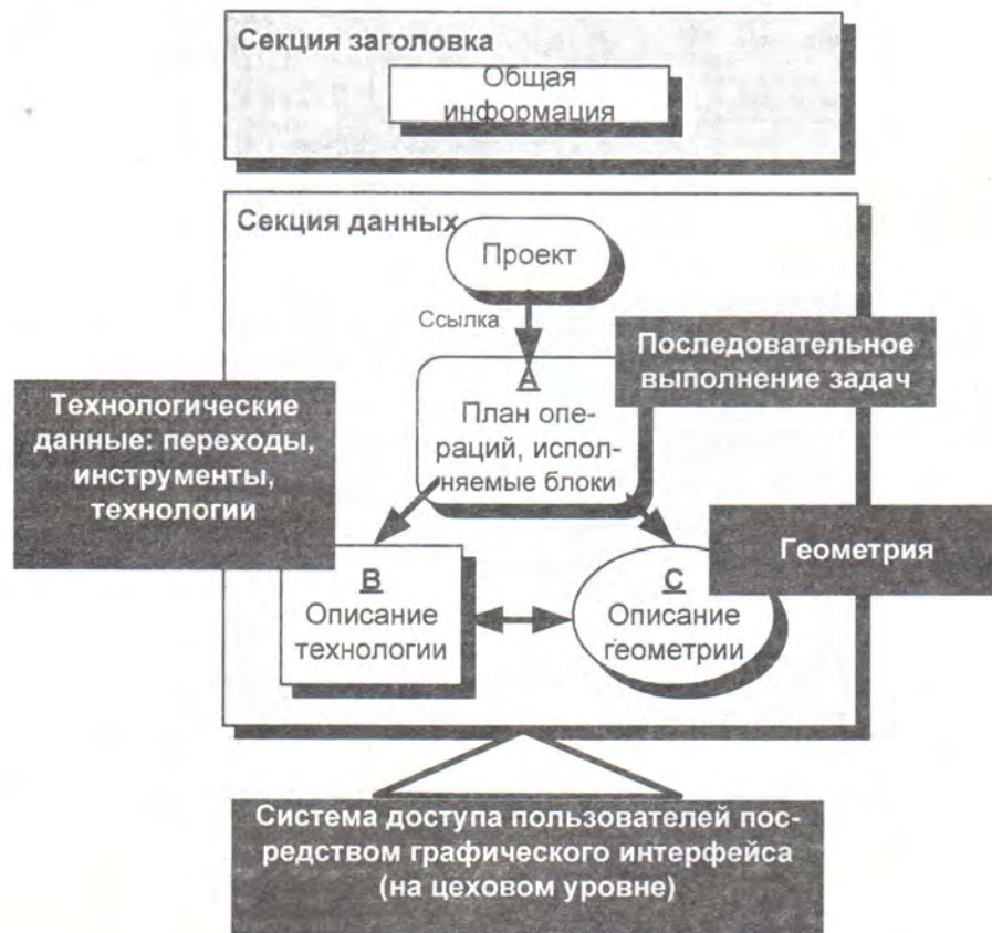
Рис. 6. Структура управляющей программы для станка с ЧПУ
