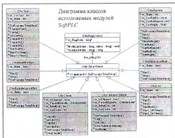
Рис. 4. Фрагмент диаграммы классов в нотации UML, реализующих исполняемые модули виртуального контроллера
