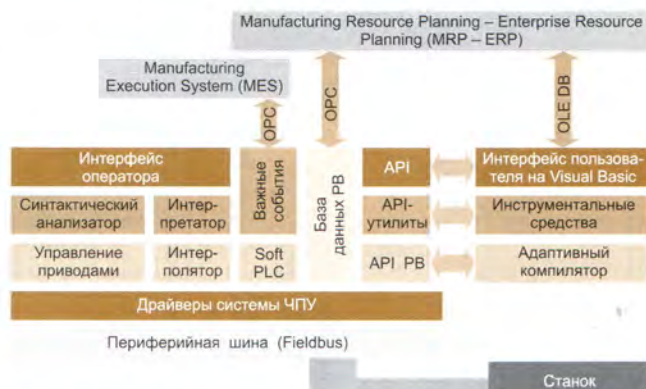
Рис. 2. Пример архитектуры открытой системы ЧПУ, где MES – Manufacturing Execution System (реальное производство); MRP – Material Requirements Planning (планирование материалов); ERP – Enterprise Resource Planning (планирование ресурсов); OPC – OLE for Process Control (стандарт для гетерогенной коммуникации); OLE – Object Linking and Embedding (связывание и внедрение объекта); DB – Data Base (БД); API – Application Programming Interface (интерфейс для прикладного программирования)
