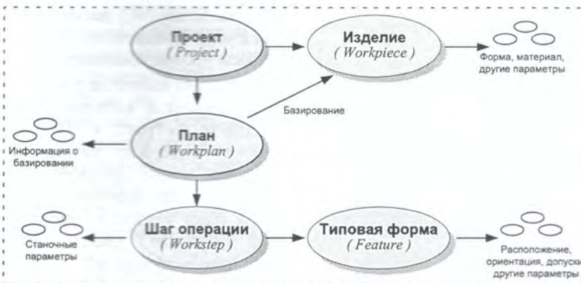
Рис. 4. Ключевые понятия и зависимости STEP-NC
