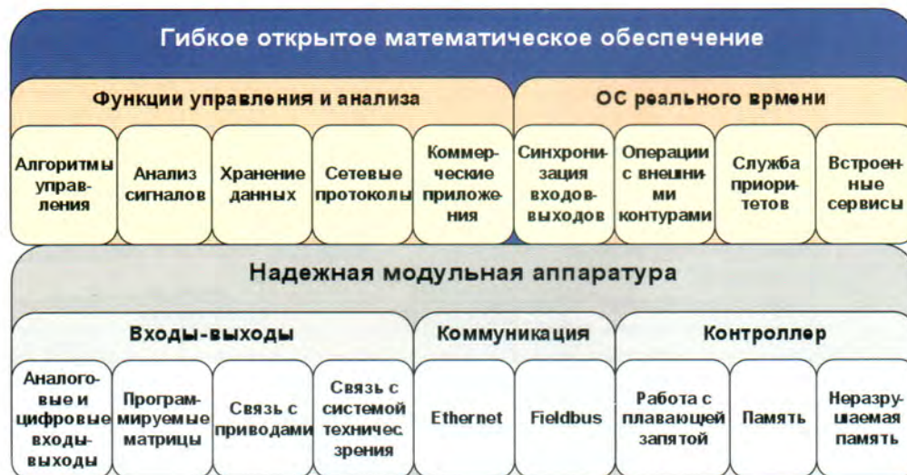
Рис. 2. Структура математического обеспечения контроллера PAC [ni.com/pac]
