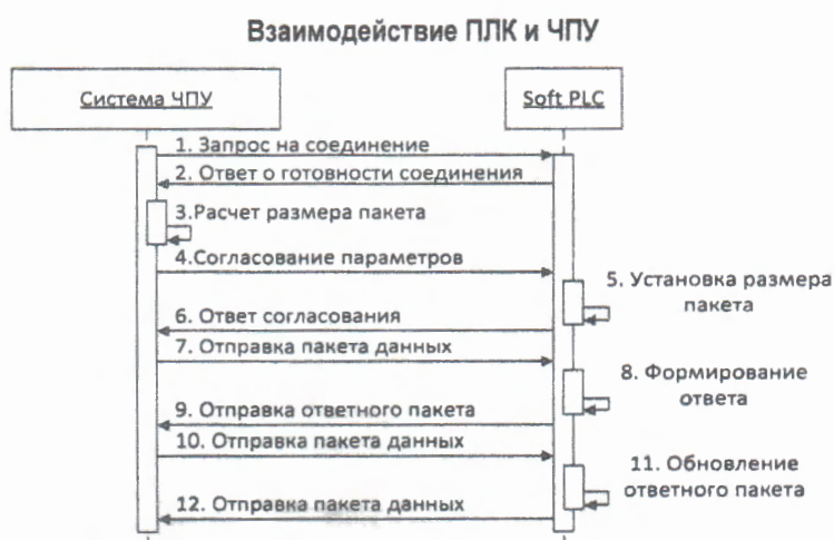
рис. 1 Диаграмма последовательности взаимодействия ЧПУ – Soft PLC
