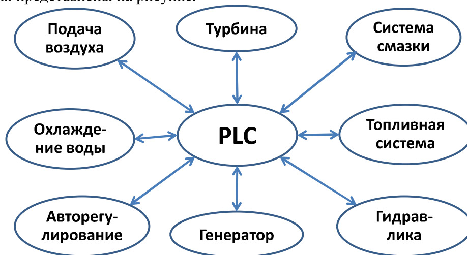
Рис. 1. Подсистемы управления газотурбинным оборудованием
