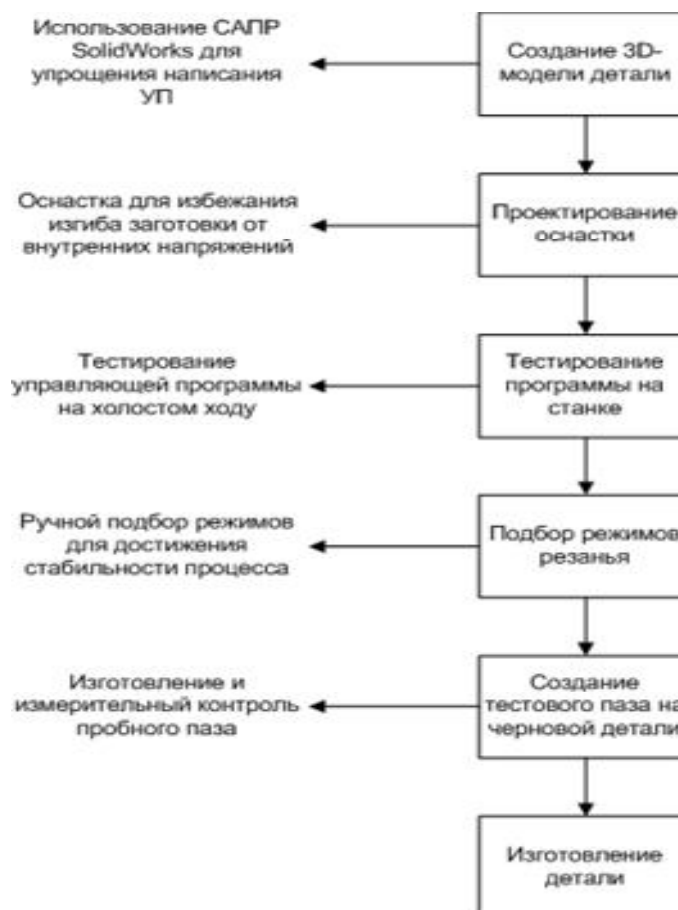
Рис. 1. Этапы изготовления тестовой детали
