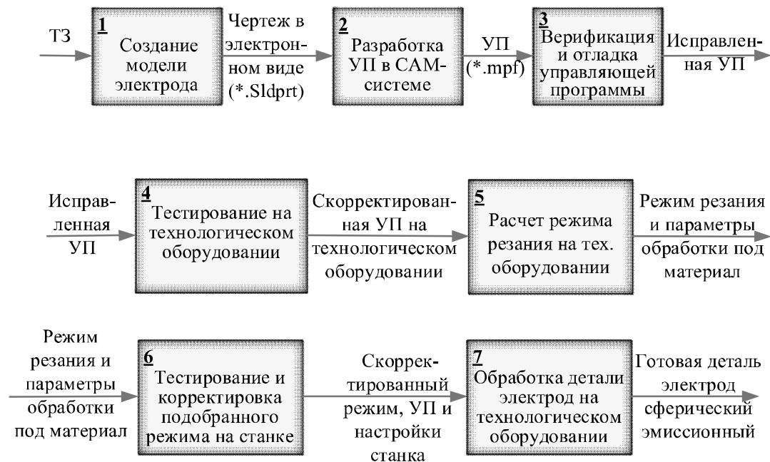
Рис. 2. Методика изготовления детали «Электрод сферический эмиссионный»
