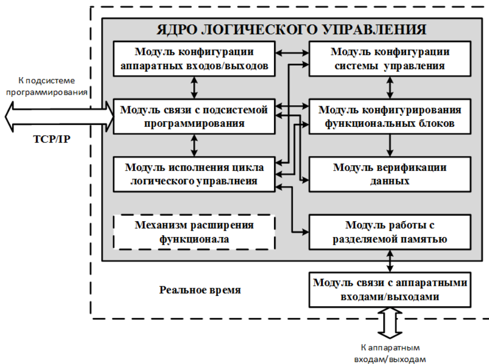
Рисунок 10 - Модули системного ядра логического управления
