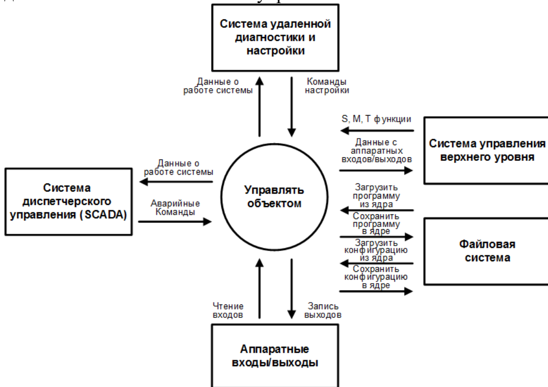
Рисунок 6 - Исходная диаграмма обобщенной поточной модели системы логического управления
