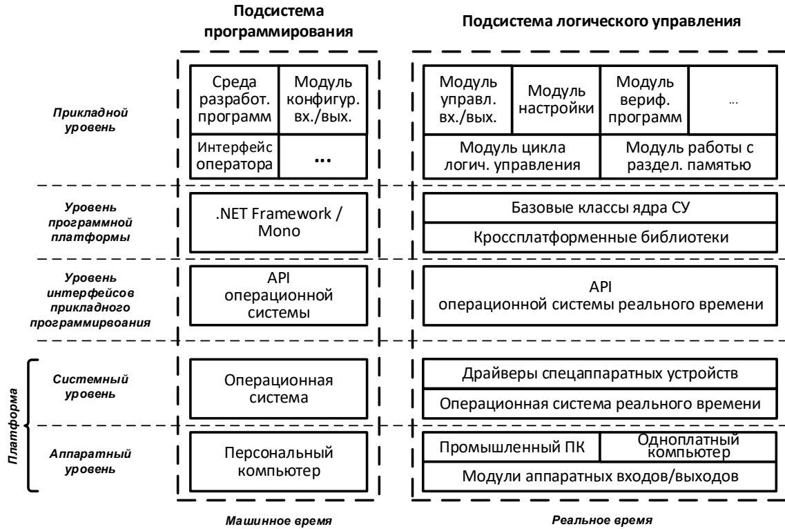
Рисунок 5 - Обобщенная модель системы логического управления по типу виртуальной машины
